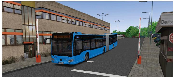
Die Dreitürer-Gelenkbusse der 17er-Baureihe verfügen im Gegensatz zum Solobus nicht über eine Fahrgastklima. Sie haben drei Innenschwenktüren und einen durchgehend niederflurigen Boden. Wie die Solobusse werden sie über einen Euro-6-Motor und eine 4-Gang-Voith-Automatik angetrieben.
