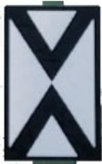
◀ Ne2 – обозначает предупреждающий светофор системы Hv или Ks.
