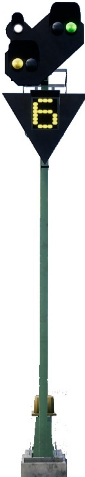
◀ Этот светофор имеет некоторые отличия. Имейте в виду, на нем отсутствует табличка №2. Наличие «ушка» с белым огнем обозначает, что это повторительный светофор, который дублирует показания следующего предупреждающего светофора, если его видимость ограничена.
