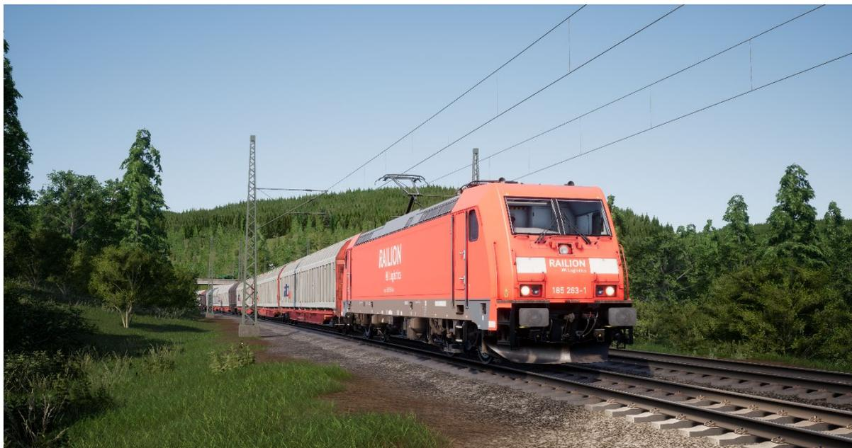
Большинство задач на этой линии выполняют локомотивы серии «TRAXX» (англ. Transnational Railway Applications with eXtreme fleXibility — «Для использования в международных железнодорожных перевозках, максимально универсальный»). Грузовые и пассажирские перевозки, двухсистемное питание, электрическая и дизельная тяга — локомотивы семейства TRAXX фирмы Bombardier соответствуют всем этим запросам железнодорожных компаний.
