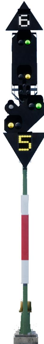
◀ Пример еще одной компоновки светофора. Предупреждающая головка на таком светофоре работает точно также, как установленная на отдельной мачте, но наличие белого огня в «ушке» говорит о том, что следующий светофор ближе, чем Вы обычно ожидаете.
