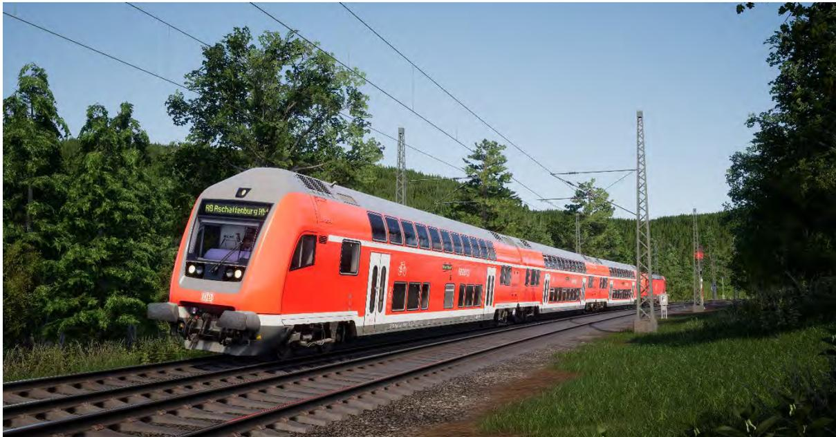
Der DABpbzfa-Steuerwagen besitzt eine unübliche Steuerposition, da der Fahrer sich am Ende eines Passagierwagens befindet, der sich nicht selbstständig bewegen kann. Stattdessen kontrolliert der Steuerwagen per Fernsteuerung die Lokomotive, die sich am anderen Ende des Zugverbands befindet.
