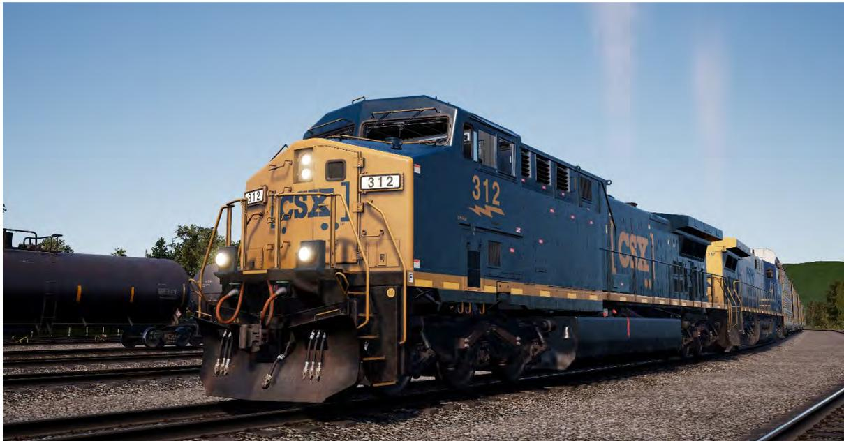
Die Messlatte für alle modernen Güterzuglokomotiven in Nordamerika liegt bei mehr als 4.000 PS, Wechselstrom und sechs Achsen - es war im Wesentlichen die bahnbrechende General Electric AC4400CW, die 1993 vorgestellt wurde, die half, diesen Standard zu etablieren.
