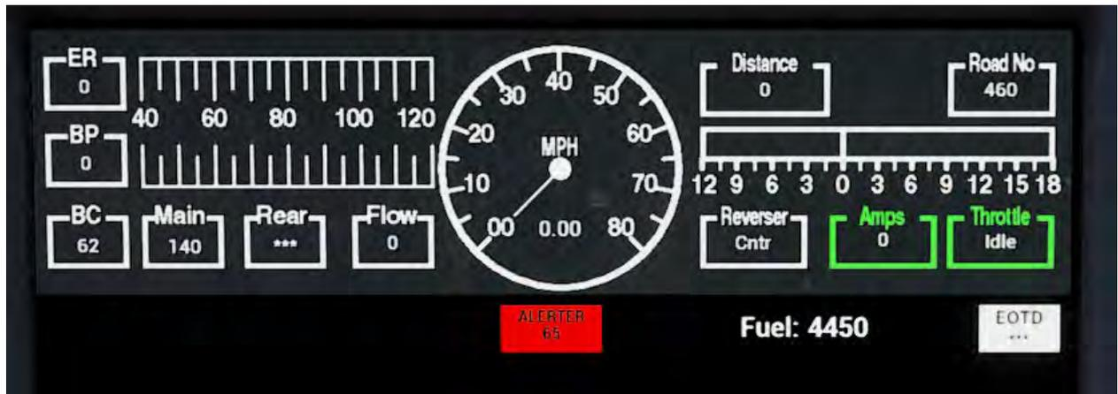
Diese Anzeige zeigt „ALERTER 65“ (Alarm 65) an. Die 65 entspricht dem Timer des Countdowns, den Sie immer sehen können. Sofern Sie schneller als 5 mph fahren, zählt er herunter, bis er 5 erreicht und den Warnton des Alerters auslöst. Den Alerter müssen Sie durch Drücken des Schalters „Bestätigen“ zurücksetzen, bevor er Null erreicht: auf dem Fahrpult, mit der **Q-Taste** auf Ihrer Tastatur oder der **B-Taste** auf Ihrem Xbox-Controller.
