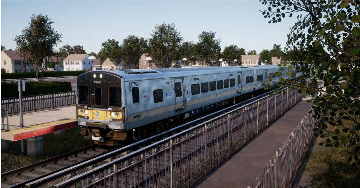
Die Elektrifizierung der LIRR begann 1905 und heute werden praktisch alle Gleise im Westen und etwa die Hälfte der gesamten Gleisemeilen mit 750 Volt Gleichstrom über die Stromschiene versorgt. Das heutige Arbeitspferd der LIRR ist eine Flotte von 836 Elektrotriebwagen der Klasse M7, die von Bombardier gebaut wurden. Der erste von ihnen wurde 2002 von der LIRR in Betrieb gesetzt.
