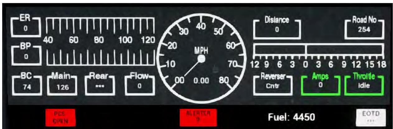
Sobald die Notbremse angelegt wurde und die Anzeige „PCS OPEN“ aufleuchtet, müssen Sie den Zug anhalten und anschließend der Prozedur zum Zurücksetzen des PCS folgen, um die AC4400CW wieder steuern zu können. Diese Prozedur wird im folgenden Abschnitt beschrieben.
