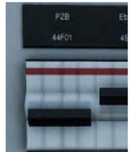
Für viele der schweren Güterzüge der Main-Spessart Bahn werden Sie im PZB-Modus **U** operieren und Ihre gesamte Höchstgeschwindigkeit auf 90 km/h festlegen müssen, um sicheres und zuverlässiges Bremsen zu ermöglichen.
