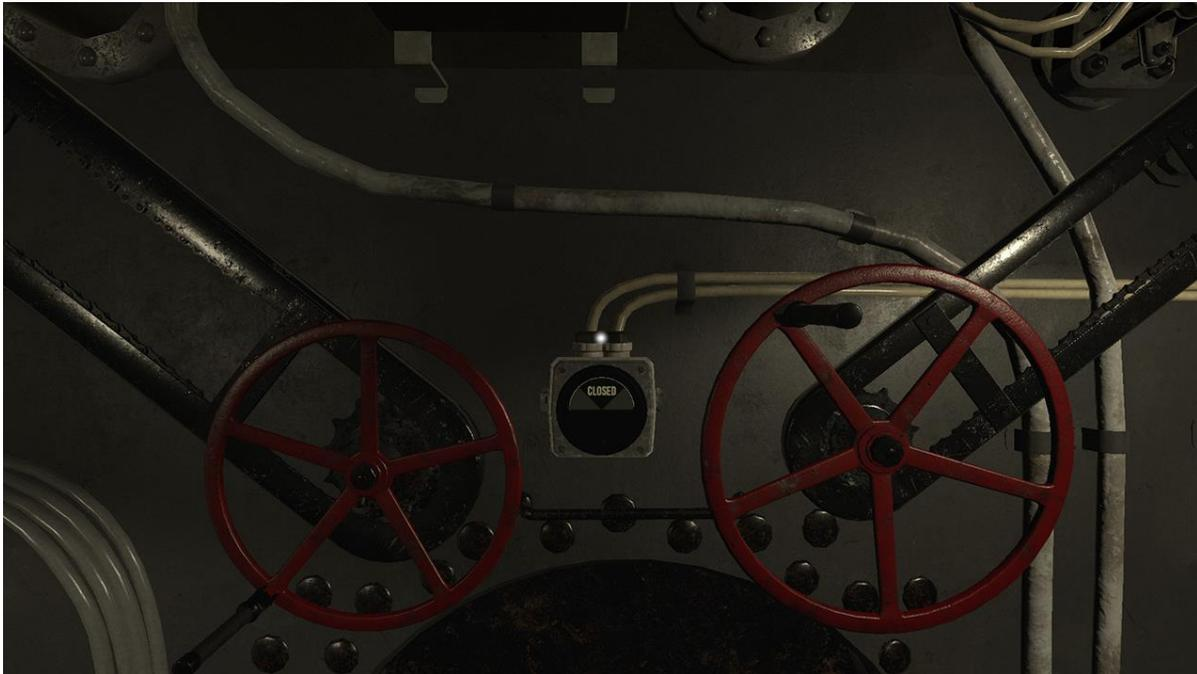
*Die Ballasttank-Ventile befinden sich im vorderen und hinteren Bereich der Zentrale.*
