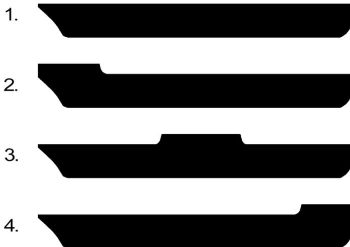
**Rumpfform** 1. Flach (Flush) 2. Vorschiff (Front) 3. Mittschiffs (Mid) 4. Achtern (Aft.).
