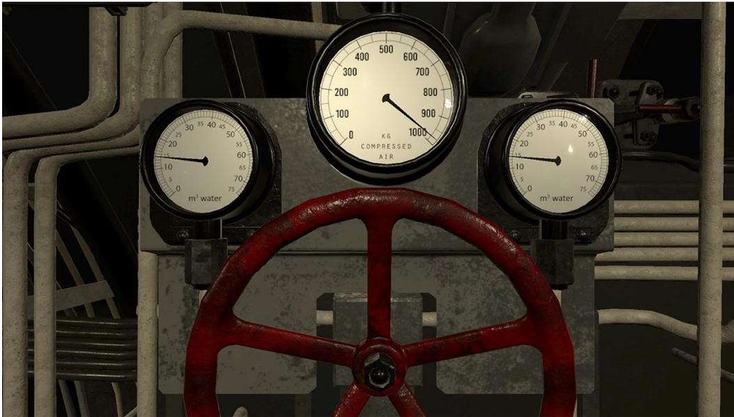
*Die Ballasttanks werden mit dem Ventil auf der Steuerbordseite des Kontrollraums angeblasen, die Wasseranzeigen über dem Ballastluftregelventil zeigen an, wie viel Wasser sich in den Tanks befindet.*
