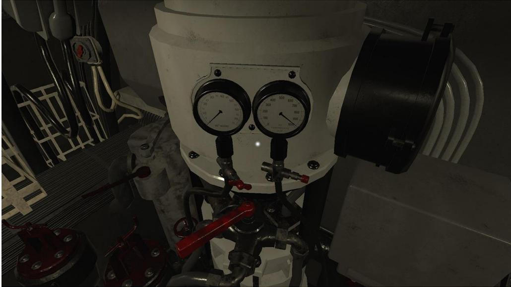
*Die Bilgenpumpe kann Wasser aus dem Boot pumpen.*
