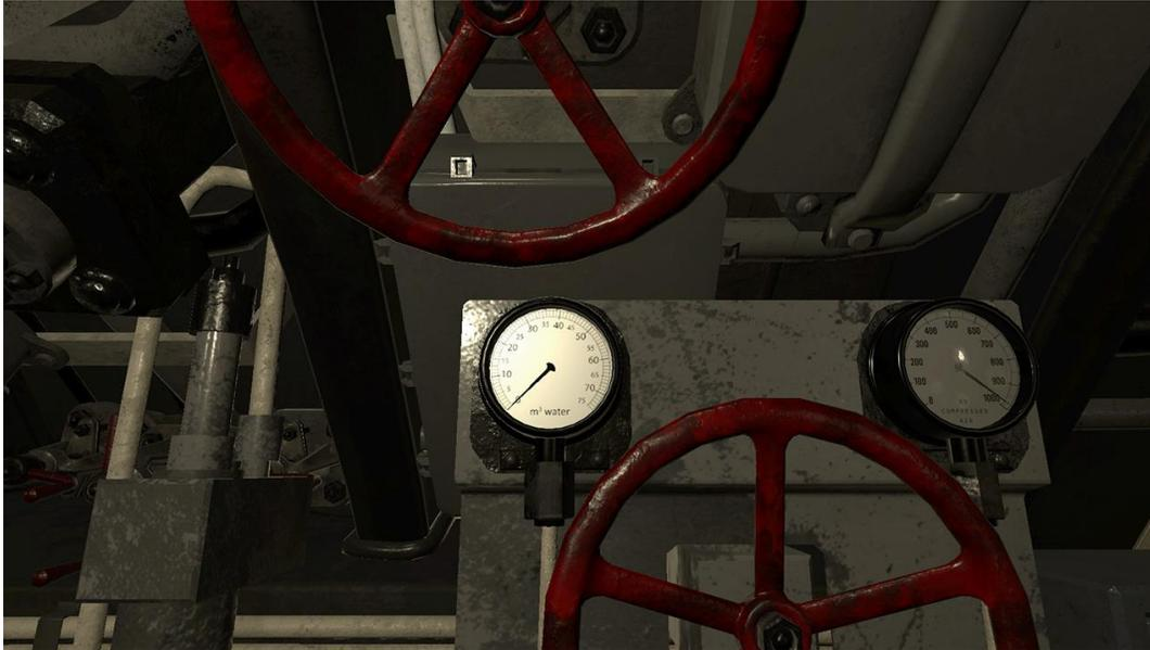
*Der Negativtank wird zum Crashtauchen verwendet. Die Kontrollstation befindet sich auf der Steuerbordseite des Kontrollraums.*
