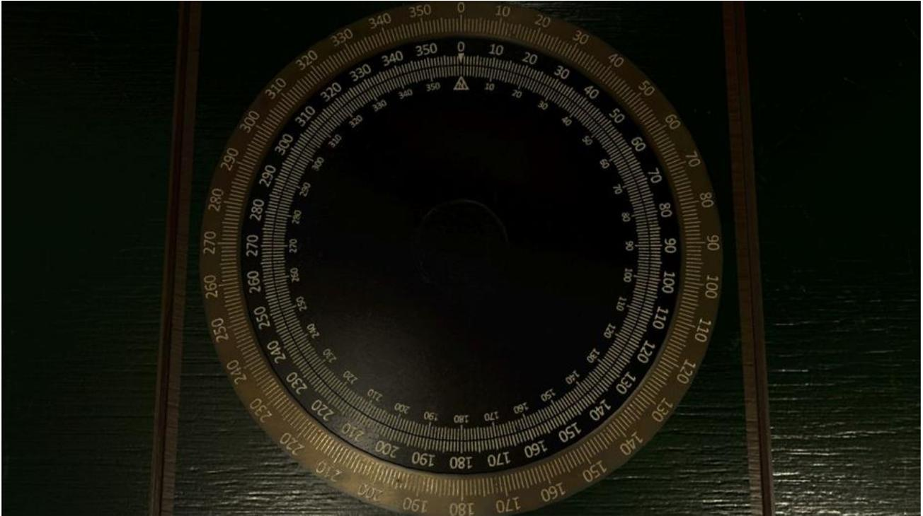
*Usa el plato con el compás montado en la mesa para hacer girar la antena. Cuando la señal se silencie, la antena estará orientada con la onda. Recuerda que, debido al hecho que la antena es simétrica, la fuente puede estar a 0 o en 180°.*
