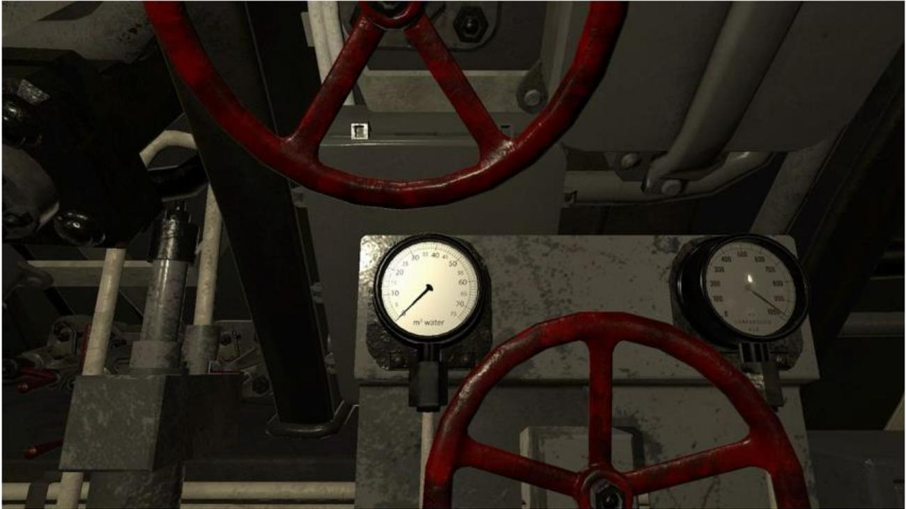
*El tanque negativo se utiliza para inmersión de emergencia. La válvula de ventilación de este tanque se encuentra en el lado de estribor de la sala de control.*
