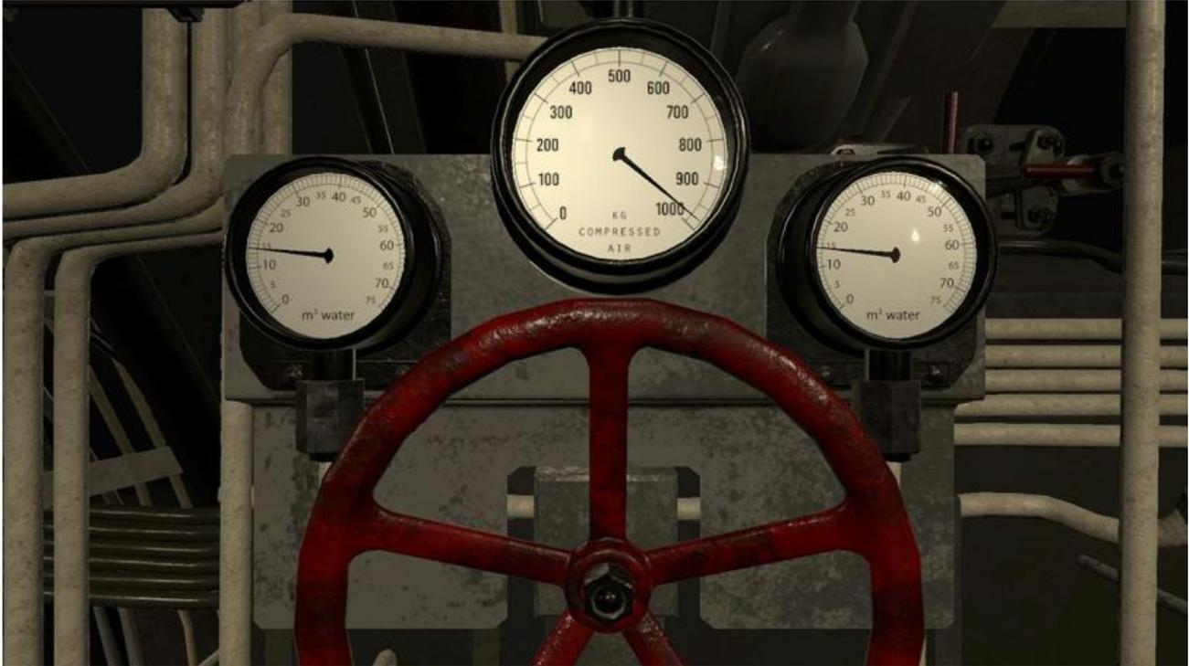
*Los tanques de lastre se soplan utilizando la válvula localizada en la banda de estribor de la sala de control. Los indicadores de agua, localizados por encima de la válvula de aire, mostrarán la cantidad de agua remanente en los tanques.*
