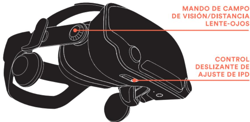
Para la mejor claridad de imagen, ponte el visor y ajusta el control deslizante de IPD. Esto va a cambiar la posición de las lentes para que coincidan con la distancia entre tus ojos.
