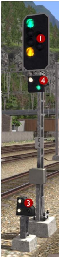
Это основной светофор (Hauptsignal), который показывает Сигнал 2, предупреждающий машиниста об ограничении скорости в 40 км/ч, которое вступит в силу в момент данного светофора.
