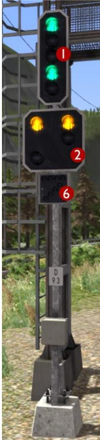
Это комбинированный светофор, основная головка которого показывает Сигнал 3, предупреждая машиниста, что ограничение скорости после данного светофора составляет 60 км/ч. Эта предупредительная головка информирует, что следующий светофор показывает Сигнал 0 (Стой).
