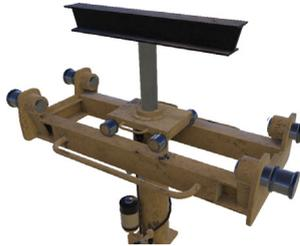
Dieser kann unterhalb des Busses im Schacht unter die verschiedenen Achsen geschoben werden. Dort kann dann die jeweilige Achse angehoben werden, um die Reifen an der Achse wechseln zu können.
