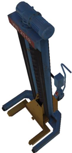
Mit Hilfe der Radgreifer kann der gesamte Bus angehoben werden. Dazu müssen jeweils alle vorhandenen Radgreifer zunächst an den Bus herangeschoben werden. Danach kann der Bus an jedem beliebigen Radgreifer angehoben und auch stufenweise wieder abgelassen werden. Dies erleichtert den Zugang zu diversen Bauteilen.
